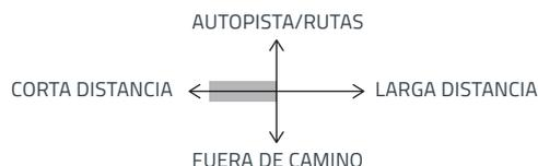
Firestone T819 es un neumático desarrollado para uso en ejes direccionales, libres y de tracción moderada en camiones y ómnibus sobre rutas mixtas (pavimento y tierra) de corta y media distancia.
